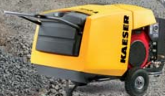
M13: Kapacitet 1.2 – 0.85 m 3 /min Radni pritisak 7 – 14 bar
