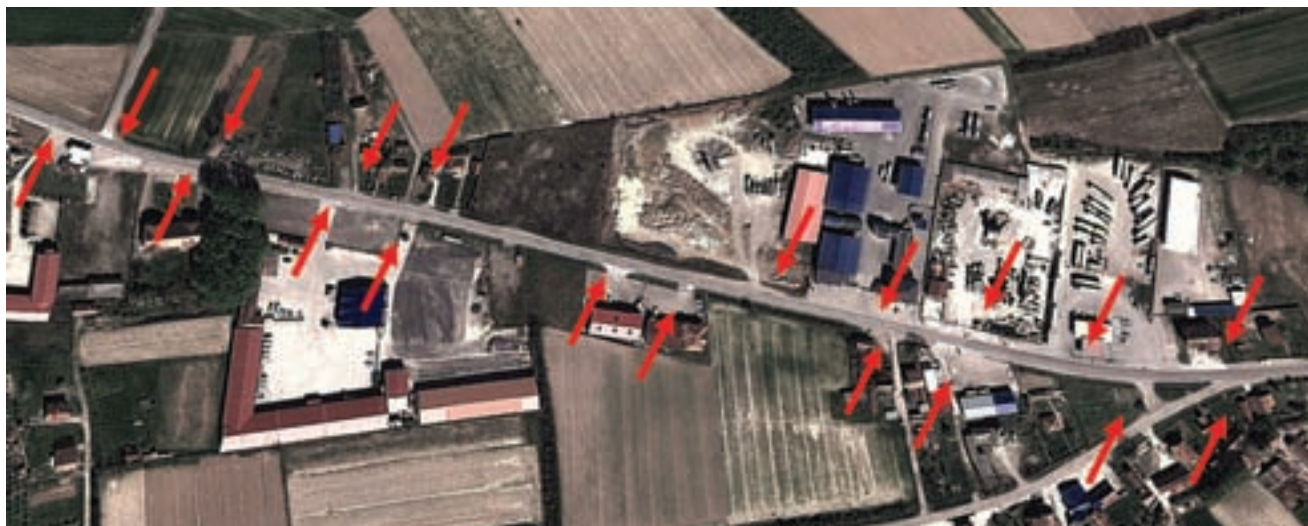
Slika 4 – Provjera bezbjednosti postojećih puteva-neadekvatna kontrola pristupa putu na vangradskoj saobraćajnici multiplicira broj konfliktnih tačaka i povećava vrijeme putovanja
