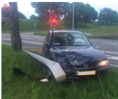
Sreća za putnike u vozilu - pogođen je pasivno bezbedan ZIP stub a ne stablo
