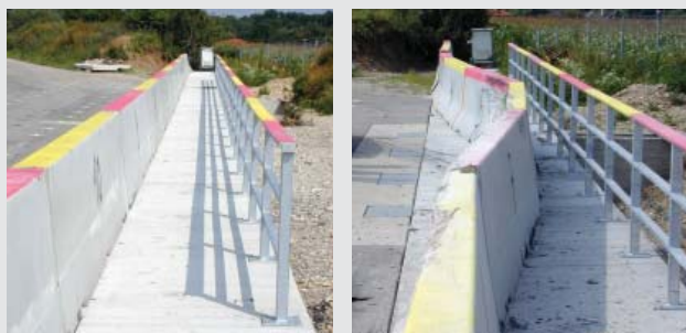
Slika ograde (levo) pre udara i slika (desno) posle udara tegljača od 38 tona
