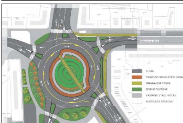
Slika 4. Postojeće dvotračno i idejno rješenje - turbo kružno raskrižje
