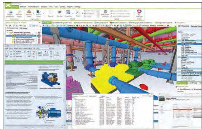
Slika 8. Povezivanje dokumentacije sa As-built BIM modelom; Bexel Manager BIM
