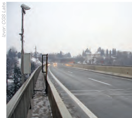
Putna meteo-stanica sa putnim senzorima ugrađenim u površinu puta
