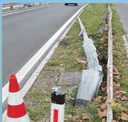
Srušen ZIP 100HE3 stub – ocenjena dužina deformacije je nešto veća od 4 m.
