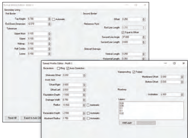
Slika 3. Unos parametara za definisanje primarne i sekundarne konstrukcije, temelja i slojeva puta
