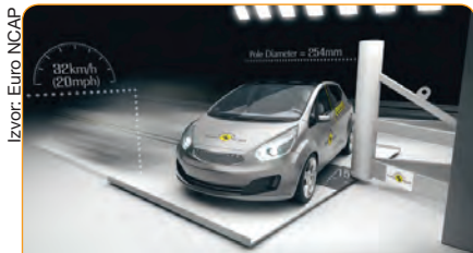
Euro NCAP testiranje bočnog udara u stub. Brzina kretanja vozila je "samo" 32 km/h što je mahom i najmanja brzina kojom se kreću vozila u svakodnevnom saobraćaju po kružnim tokovima.
