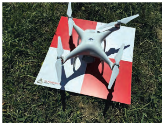
Slika 1. Bespilotna letjelica Phantom 4 sa tablom za fotosignalisanje kontrolnih tačaka
