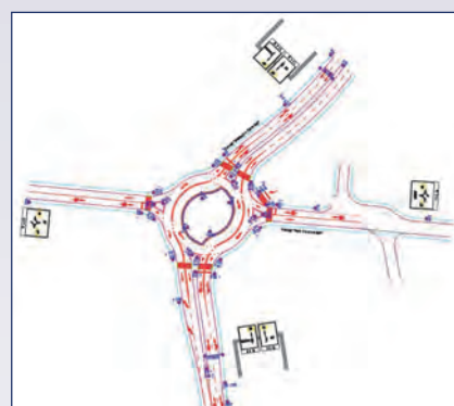
Turbo kružni tok, između ulica Zapaden Bulevar i 8. Septemvri u Kavadarcima
