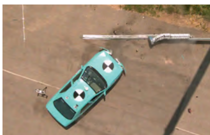
Vozilo nakon udara tip 3 (TT 3.3.110) ostaje u zoni zadržavanja (exit box), trajni bočni pomak konstrukcije je minimalan
