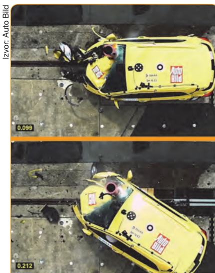
Dubina prodora fiksnog stuba pri brzini od 80 km/h u vozilo Opel Mokka
