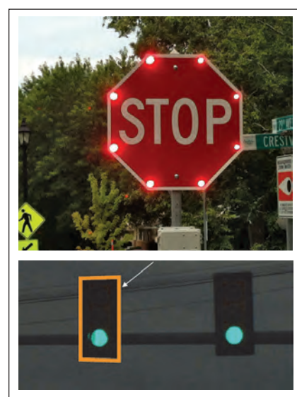
Slika 14. Led diode na znaku STOP i fluorescentna ivica glave semafora
