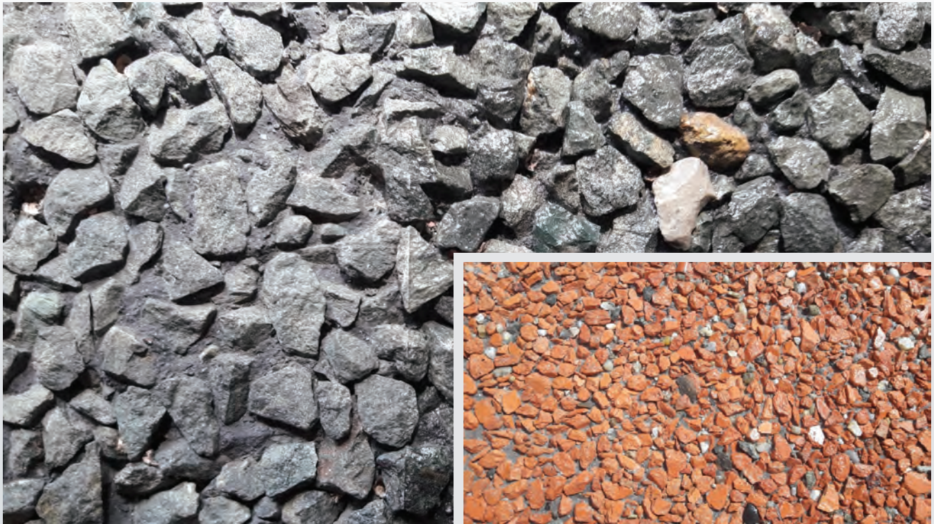
Slika 5: Različite varijante izvedbe elemenata od pranog betona
