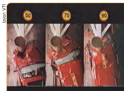
Posledice udara u stub kod različitih brzina
