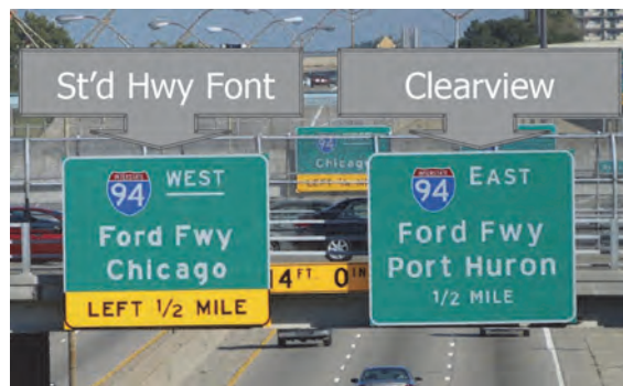
Slika 13. Čitljivost novog stila slova Clearview (na desnom znaku) veća je od starijeg propisanog stila tzv. E fonta (na levom znaku) za 16 %
