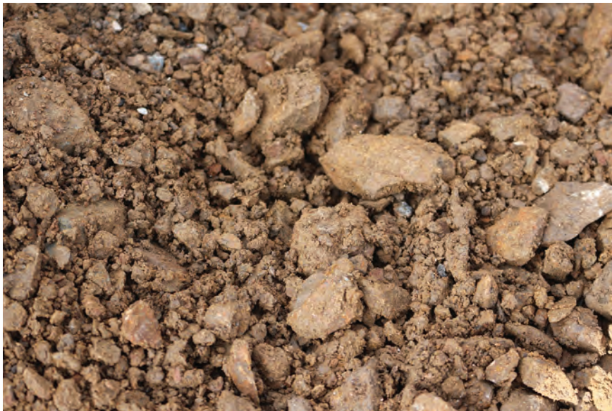
Slika 4. Nevezani granulisan materijal uzorkovan iz sondažne jame, D_{max}=31 mm
