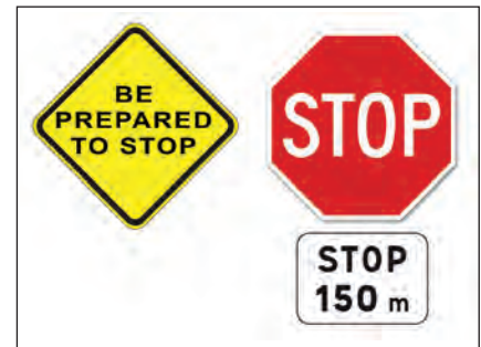
Slika 8. Signalizacija koja upozorava, odnosno priprema vozača na sledeću signalizaciju
