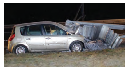
Sistem vođenja sajlama funkcionisao je svaki put drugačije, što ne govori u prilog pouzdanosti sistema
