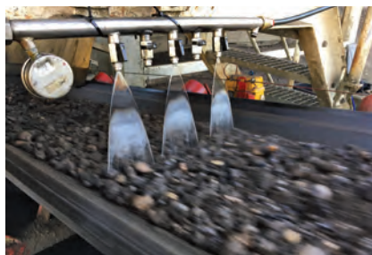
Tretiranje struganog asfalta direktno pomoću SYLVAROAD™ RP1000 pre obrade asfaltno mešavine
