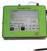
Pile Integrity Tester (PIT) Ispitivanje integriteta
