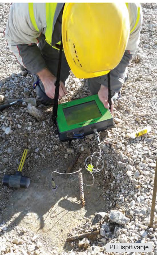
Pile Integrity Tester (PIT) Ispitivanje integriteta
