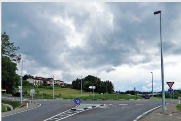
Kružna raskrsnica opremljena ZIP pasivno bezbednim stubovima
