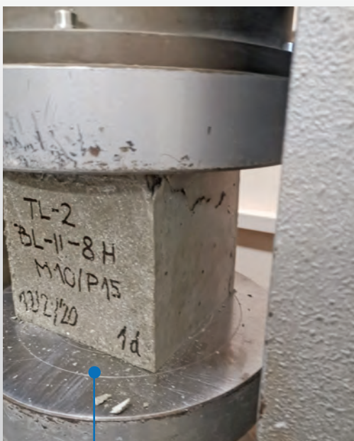
Ispitivanje tlačne čvrstoće nakon jednog dana
