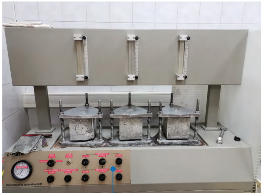
Ispitivanje vodonepropusnosti betona
