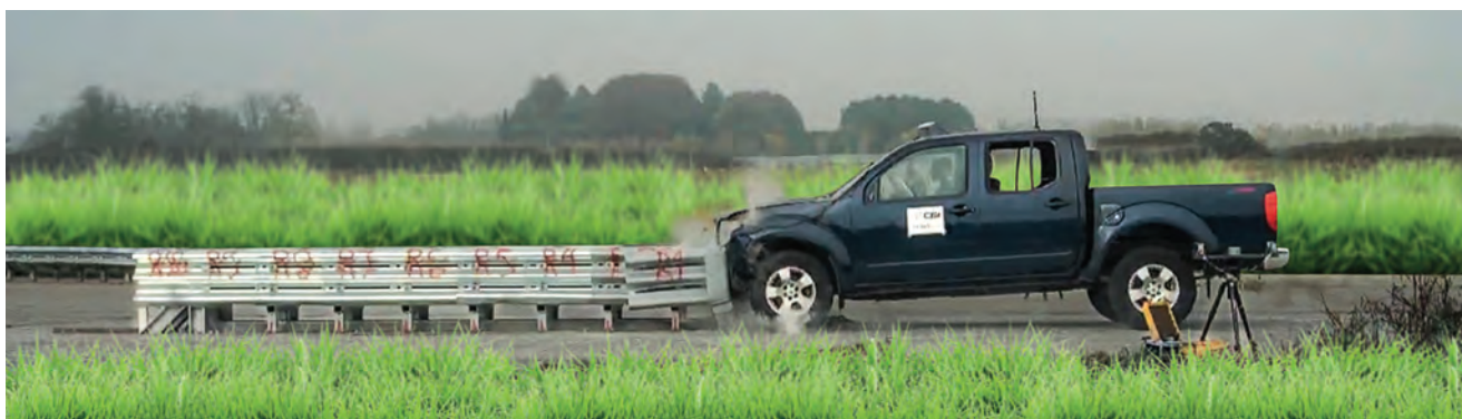
Udar teškog vozila sa 100 km/h - testna lutka nije ni dotakla air-bag što dovoljno govori o promišljenom načinu apsorpcije udarne energije.
