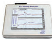
Pile Driving Analyzer (PDA) Ispitivanje nosivosti
