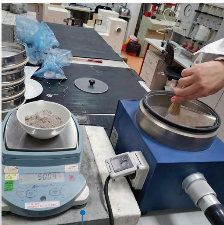
Ispitivanje granulometrije biopepela
