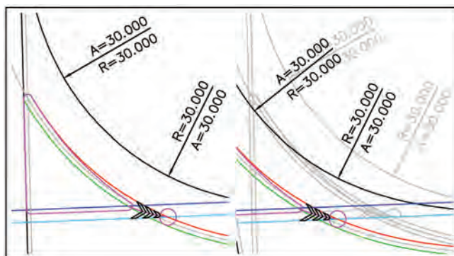
Slika 17. Markacija vrha ostrva - Komanda X-MARK-NOSE
