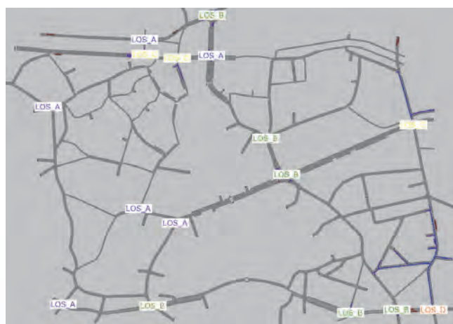
Slika 2. Izrada modela u softverskom paketu VISSIM
