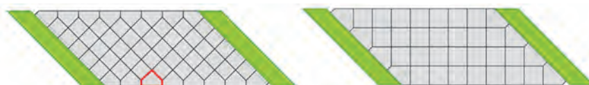
Slika 12. Raspored spojnica kod betonskog kolovoza odmorišta: a) normalno na pravac parkiranja b) normalno na prolazne saobraćajne trake, izvor: [10]
