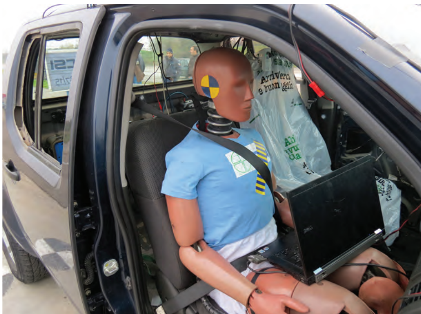
Neke probe udara vozila su bile urađene i sa testnom lutkom. Tako se najbolje može oceniti uticaj udara na putnike u vozilu.
