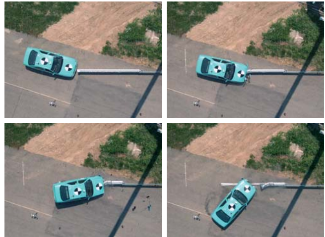
Primer korektno delujuće početno završne konstrukcije SMA Ermes: vozilo se zaustavlja u neposrednoj blizini konstrukcije sa karakteristikama po prEN 1317-7: Z1, S0,5 V0,5 U0, ASI B.
