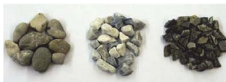
Slika 5: a) potpuno zaobljena zrna agregata, b) drobljena zrna agregata, c) potpuno drobljena zrna agregata (Blab 2 (o.J.))
