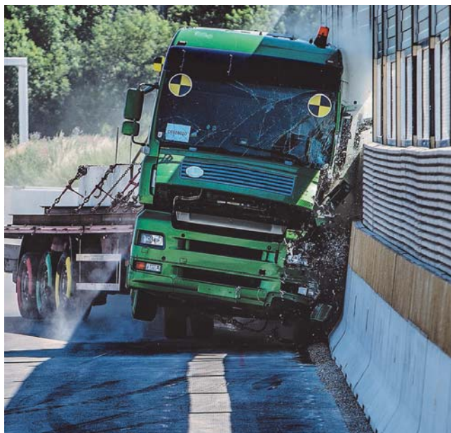
Betonska montažna zaštitna ograda DELTABLOC® DB 150 NBF, nivo zaštite H4b sa integrisanom barijerom protiv buke serije PHONOBLOC®, ukupne visine sistema zvučne barijere i do 6 m.
