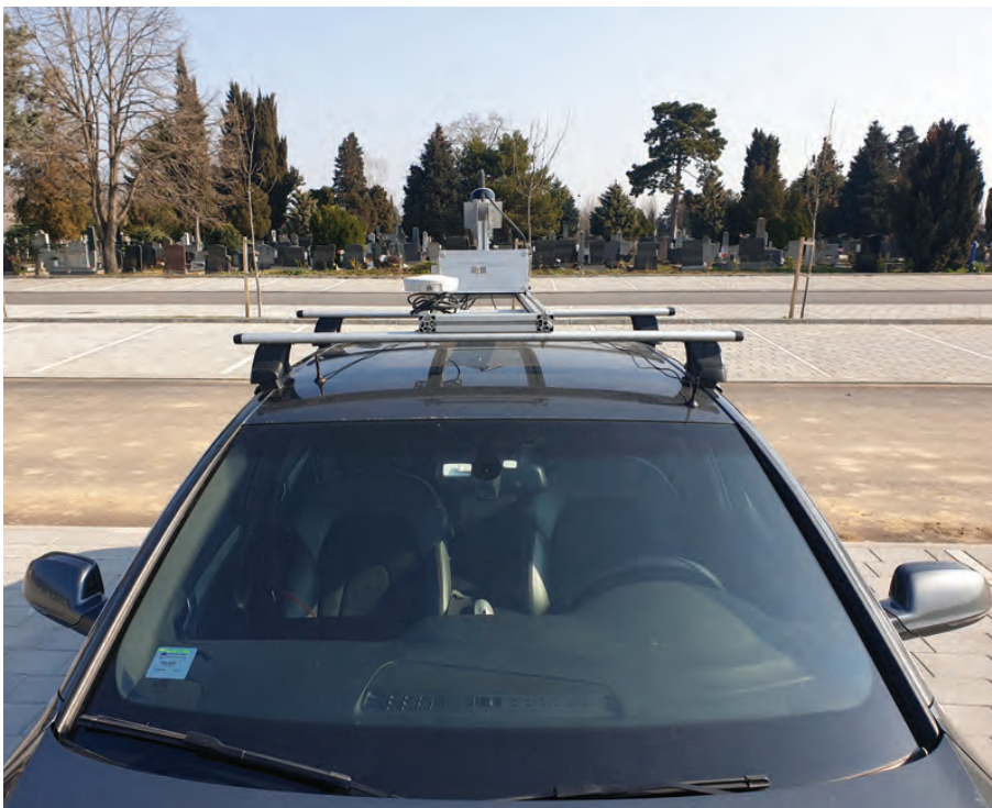
LIDAR - laserski sistem montiran na automobil radi snimanja putne deonice za potrebe analize preglednosti
