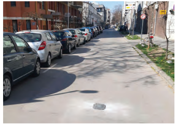
Mobilni brojač postavljen u jednosmernoj ulici u naselju
