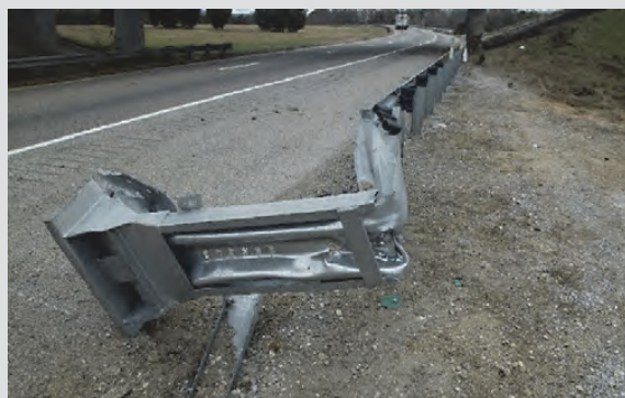
Slika 7. Blokirani takozvani Extruder Terminal. Plašt ograde je već nakon par metara zaglibio u profilu za deformaciju i tako sprečio istiskivanje plašta kroz kliznu glavu.
