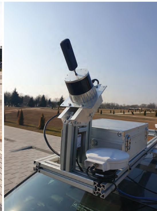
LIDAR - laserski sistem montiran na automobil radi snimanja putne deonice za potrebe analize preglednosti
