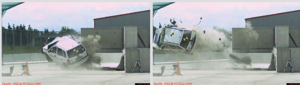
Slika 4. Katapultiranje vozila - jedan koso postavljeni element betonske ograde.
